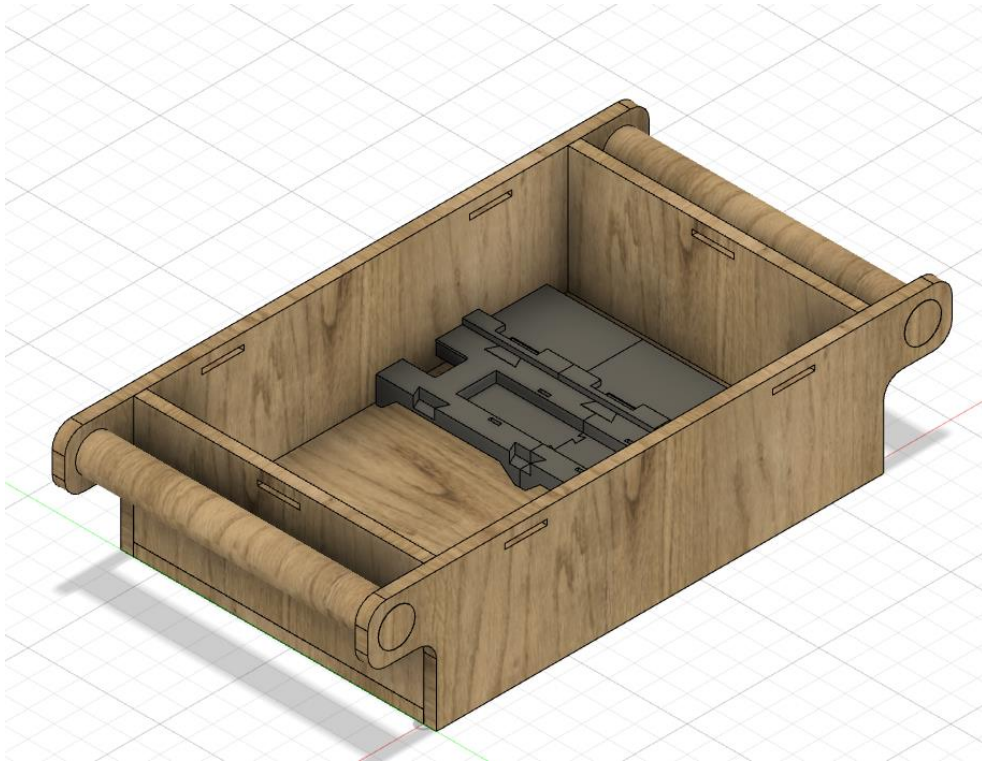
(4) 3D CAD Zeichnung von den Holzteilen und den Teilen aus dem 3D Drucker
