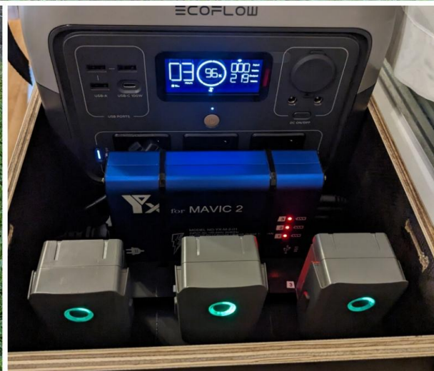
(1) Oben und unten links: Montierte und einsatzbereite Plug&Play Kitzretter-Ladebox Unten rechts: Plug&Play Ladebox im Betrieb
