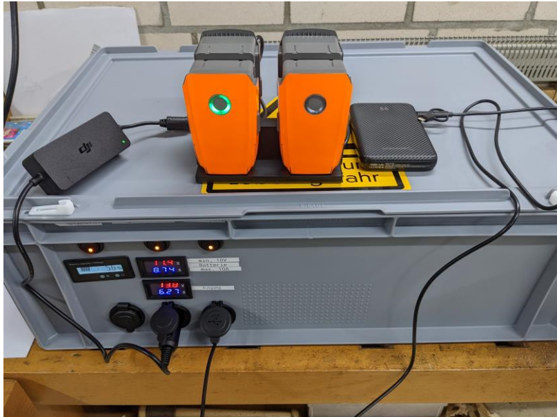
(2) Kitzretter-Ladebox 1.0 beim sequentiellen Laden von vier Drohnenakkus und einer Powerbank
